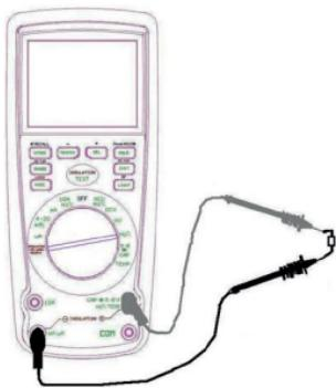
1. Zet de functieschakelaar op de **rode INSULATION** positie en druk op de RANGE-toets om de juiste testspanning te selecteren ( deze wordt getoond in de linker bovenhoek)
