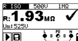
Figuur 17 Voorbeeld van meetresultaten isolatieweerstand
