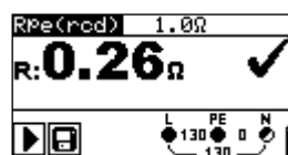
Figuur 6.5: Voorbeelden van de PE-geleider meting resultaten.
