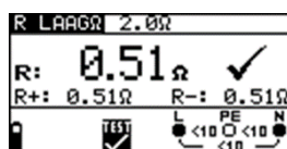
Figuur 22 Voorbeelden van meetresultaten van de weerstand R_{LAAG}
