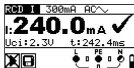
Figuur 34 Voorbeeld meetresultaat uitschakelstroom
